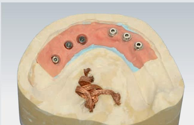
11] Il modello master SAE di forma stabile con le repliche abutment degli impianti SAE rimovibili che per il processo di elettroerosione vengono sostituite da elettrodi di rame per elettroerosione.
