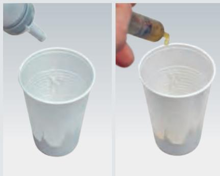
2] Dosaggio: resina epossidica: 6 parti (ml) indurente epossidico: 1 parte (ml) ...
